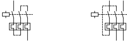
Abbildung 6: Verdrahtung der Motorschutzrelais für den Schutz von Wechselstrom- oder Gleichstrommotoren (Reihenschaltung der Bimetallauslöser)
