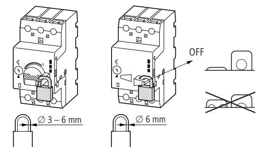
Le PKM 0-... est un organe de protection contre les courts-circuits. Quant aux surcharges thermiques, il n'est pas autoprotégé et ne protège pas les installations. Il faut donc prévoir des organes de protection externes contre les surcharges thermiques. Avec les ensembles démarreurs, la protection contre les surcharges est assurée par l'association d'un relais thermique.
