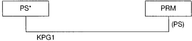
Die Transferfunktion PRM → PS kann nur im Halt-Zustand der Steuerung ausgeführt werden. Dabei werden die Programme im RAM-Speicher überschrieben. Die Transferfunktion PS → PRM und Verify können auch im RUN-Zustand der Steuerung aufgerufen werden.
