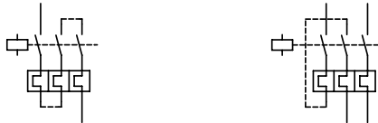
Abbildung 5: Verdrahtung des Motorschutzschalters für den Schutz von Wechselstrom- oder Gleichstrommotoren (Reihenschaltung der Bimetallauslöser)
